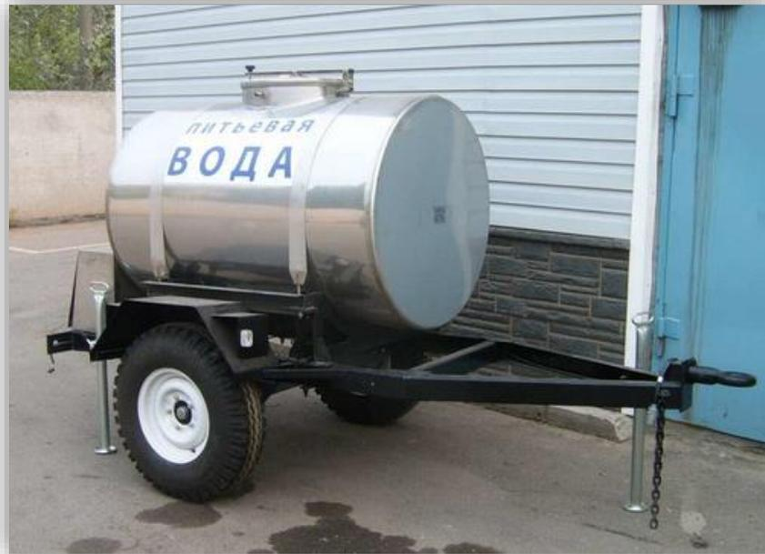
Рисунок 4.14. Передвижная цистерна для подвоза воды
