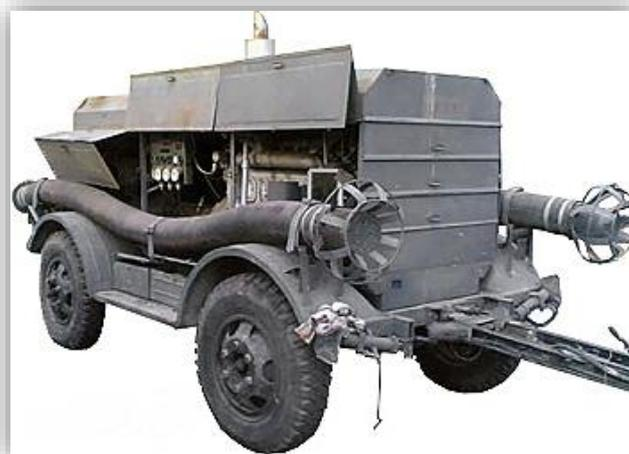
Рисунок 4.26. Передвижная насосная станция СНП 75/100
