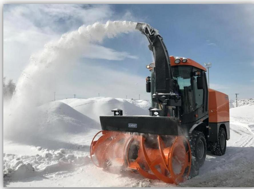
Рисунок 4.18. Роторная снегоуборочная машина
