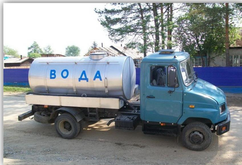
Рисунок 4.8. Автомобиль с цистерной для подвоза питьевой воды
