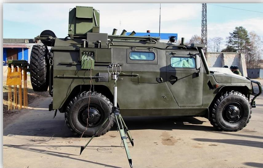
Рисунок 4.23. Разведывательная химическая машина
