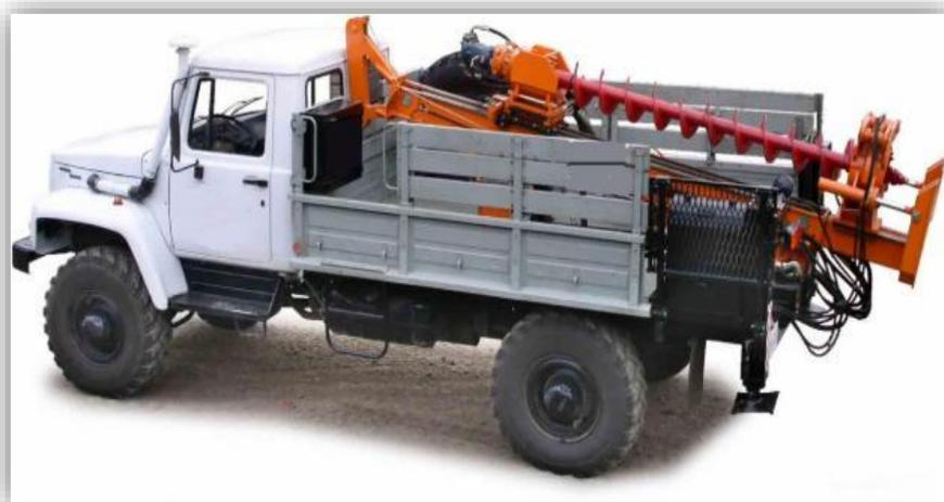
Рисунок 4.27. Буровая установка КШК-30 на автомобильном шасси
