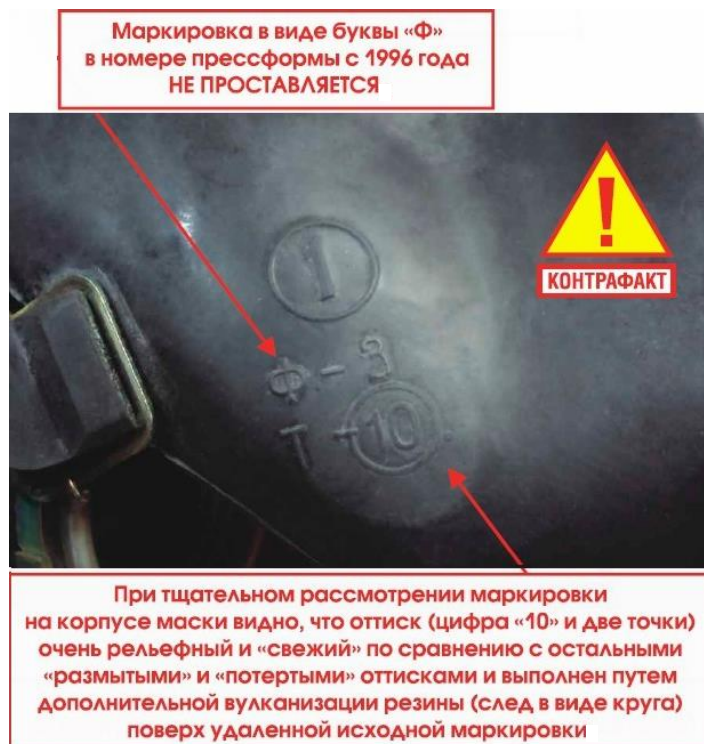
Рисунок 4.13. Пример контрафактной лицевой части противогаза ГП-7
