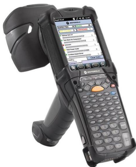
Рисунок 4.16. Считывающее устройство RFID-меток
