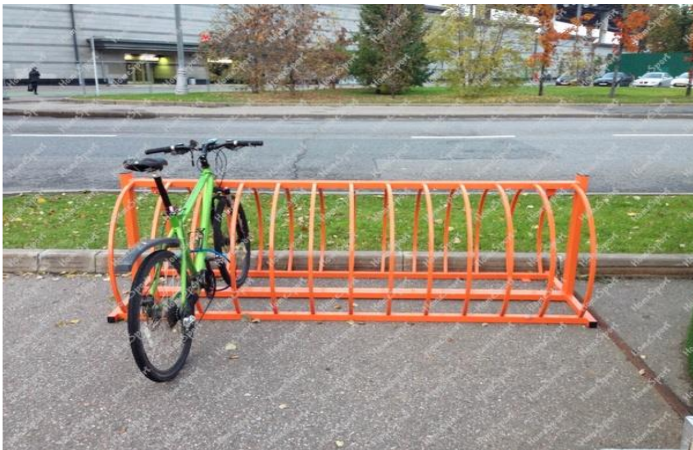
Рисунок 4.21.4 – Парковка велосипеда по типу «стенд»
