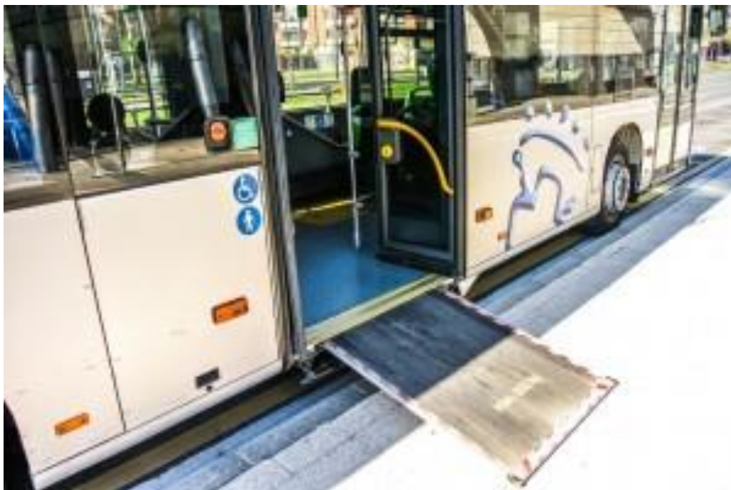
Рисунок 4.19.1 – Автоматический выдвижной пандус для инвалидов
